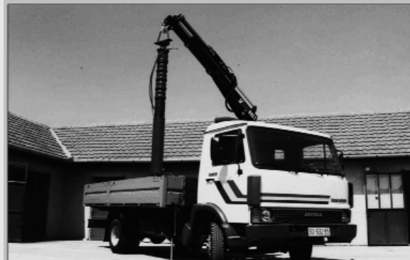
Дзвигане и спущуєме пумпи до глібоких студньох
